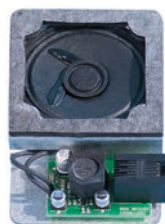
Module audio micro + haut-parleur (HP) dans cabine
